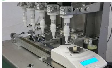
(I管型供給機-5台- 天びんスライダー)
